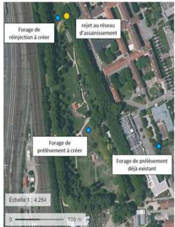
points de captage et rejet prévus sur le même site : l'hôpital saint Jean de Dieu à Lyon 8e
