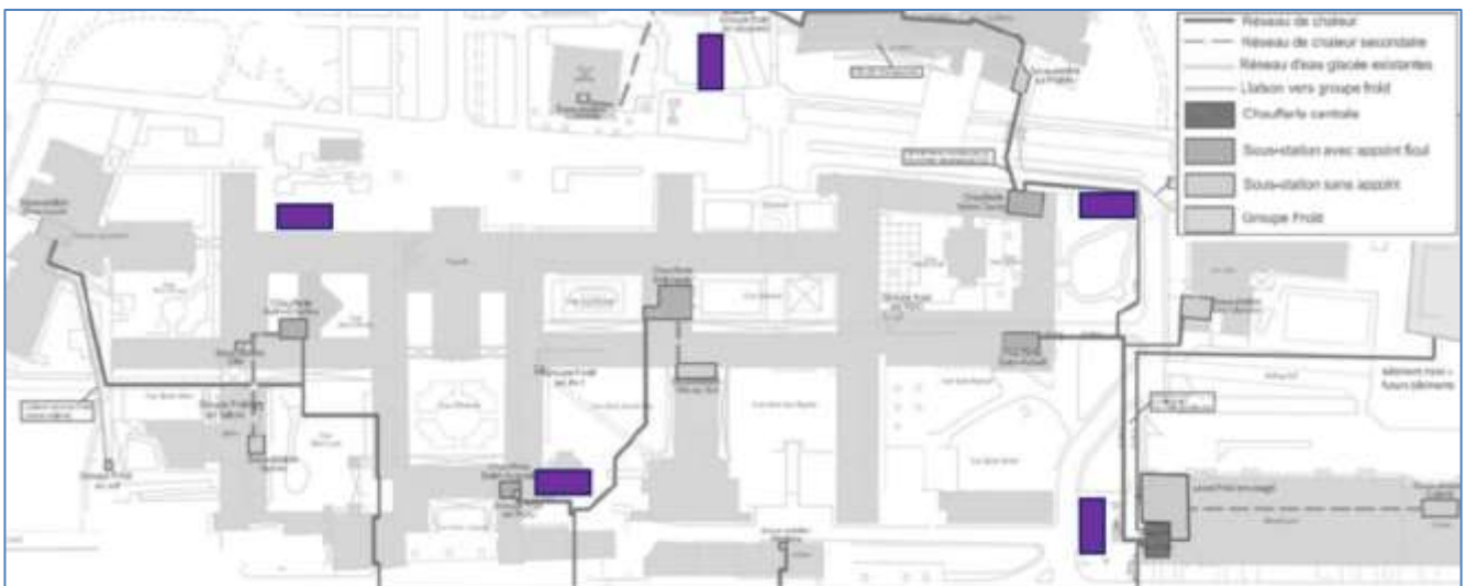
1 Localisation des cuves à fioul et des groupes froid sur le site de l’hôpital – à droite la chaufferie centrale
