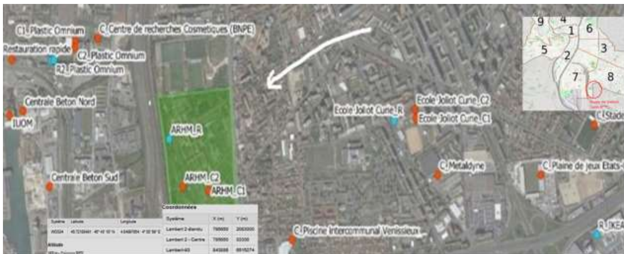
Captages (rouge) et rejets (bleu turquoise sur cette carte) la flèche indique le sens écoulement de la nappe Les points de captage de l'hôpital st Jean de Dieu sont désignés ARHM_C1 et ARHM_C2, le point de réinjection ARHM_R
